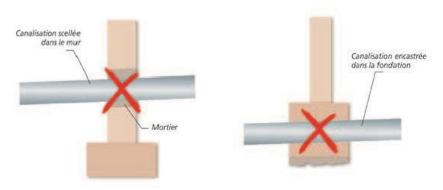
Conditions de mise en œuvre: Les canalisations seront réalisées avec des matériaux non fragiles (c'est-â-dire susceptibles de subir des déformations sans rupture). Elles seront aussi flexibles que possibles, de façon à supporter sans dommage les mouvements du sol.
