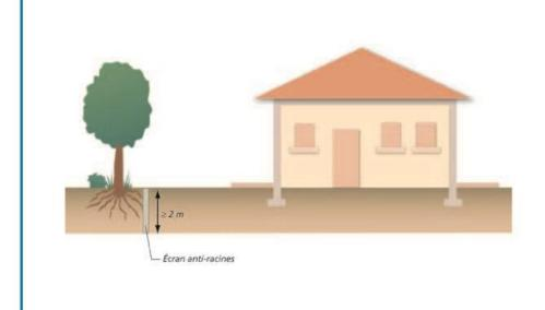
**Précautions de mise en œuvre**: L'écran anti-racines doit pouvoir présenter des garanties de pérennité suffisantes, notamment vis-à-vis de l'étanchéité et de la résistance. Un soin particulier doit être porté sur les matériaux utilisés (œractéristiques de la géomembrane, etc). L'appel à un professionnel peut s'avérer nécessaire pour ce point, voire également pour la réalisation du dispositif.
