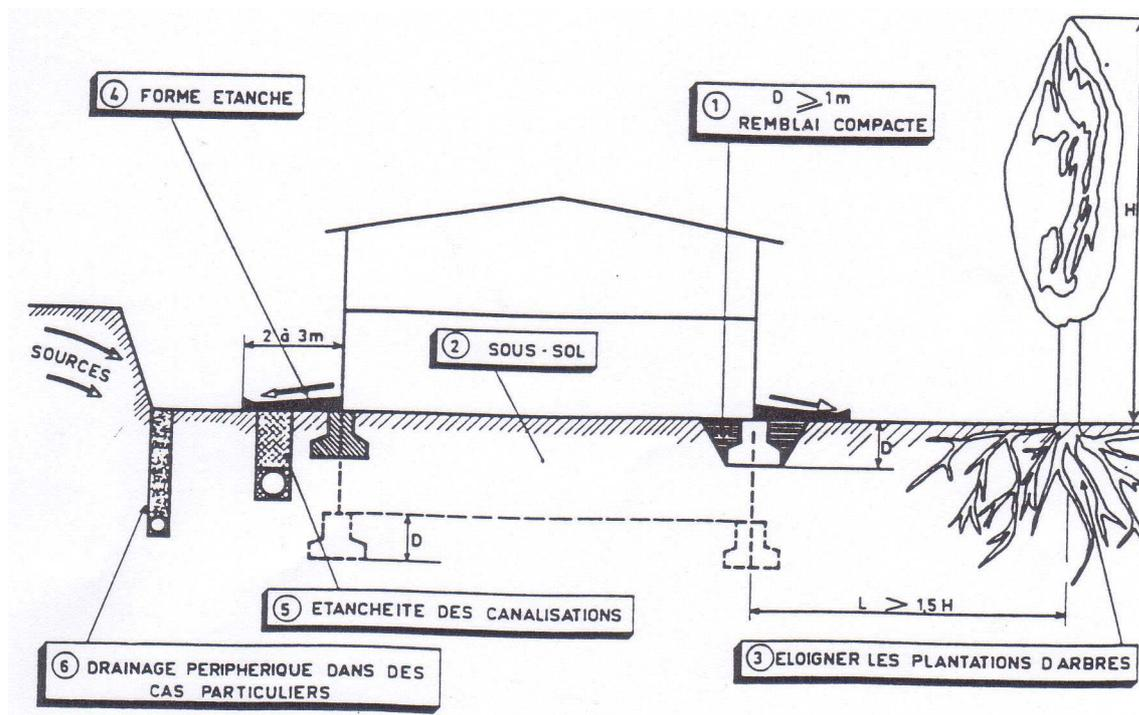
*Fig.1 : Mesures destinées à éviter les variations d'humidité sous les fondations*
