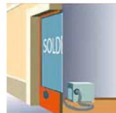
Le climatiseur portable est placé à l'intérieur du local avec une bouche de sortie dans la menuiserie.
