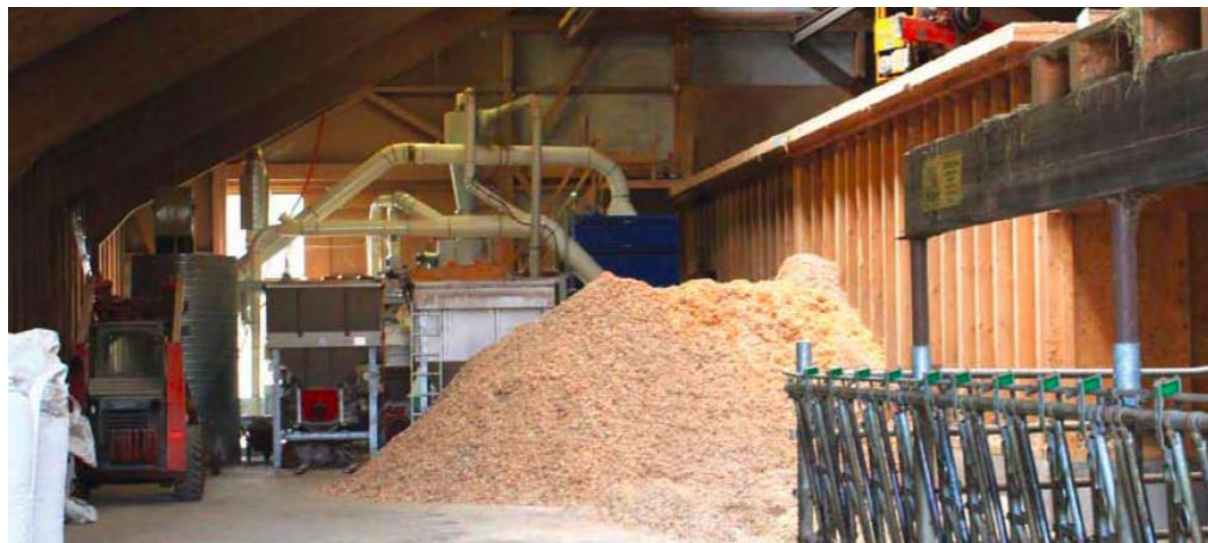
(Exemple de système de production de granulés à partir de plaquette forestière. Ligne de granulation, caissons de séchage forcé, matériel de manutention... Unité fournissant 2500 T/an source : granulenergie.fr)
